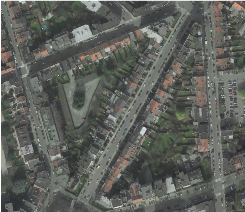
Réalisé avec Brussels UrbIS® – Deux îlots triangulaires de part et d’autre de la rue Jules Lejeune (Ixelles). À gauche la densification de l’îlot au profit d’un parking a fait chuter la trame végétale comprise en cœur d’îlot au profit de sols imperméables minéralisés. Ici la vulnérabilité à l’ICU est accrue et avec une densification en cœur d’îlot.
