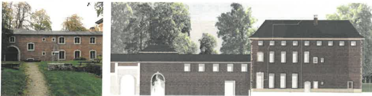
Extraits du dossier - Le visuel montre la façade suite à la démolition de l'extension de l'aile est, en situation projetée. La façade qui sera dégagée au terme de cette intervention, côté ville, est la façade d'origine. Elle sera maintenue, mais recomposée. Le traitement prévu est contemporain : succession de baies carrées au 1er étage, équipées de châssis contemporains, et large baie vitrée au RDC.
