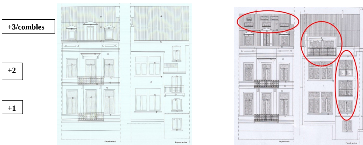
Façades avant et arrière : états existant et projeté (illustrations extraites du dossier)
