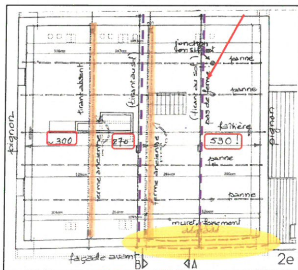
Charpente, façade à rue disloquée et schéma de la charpente – extraits du dossier
