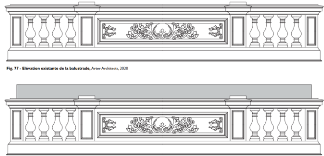
Fig. 78 - Proposition de rehausse de la balustrade, Arter Architects, 2020
