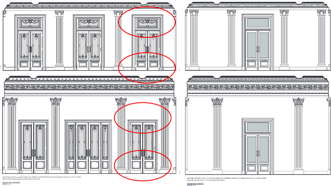
Dessins des portes existantes à gauche, et des portes projetées à droite, joints à la demande
