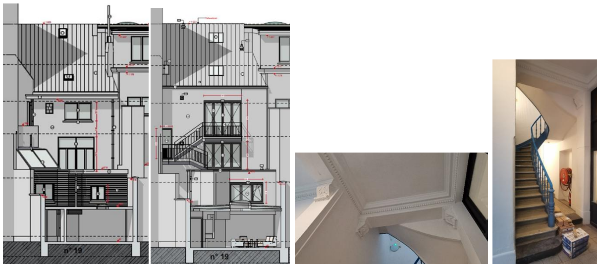
Façade arrière : situation existante et projetée (extr. du dossier de demande), vues actuelles de la cage d'escalier (©Urban.brussels, 2021)
