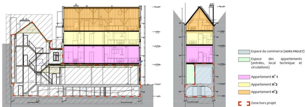
Fig. 2 - Coupes schématiques du projet de restauration et de réaffectation, 2020, © ARTER
