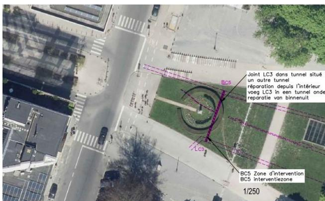
Plan masse avec en mauve la localisation du joint en partie classée
