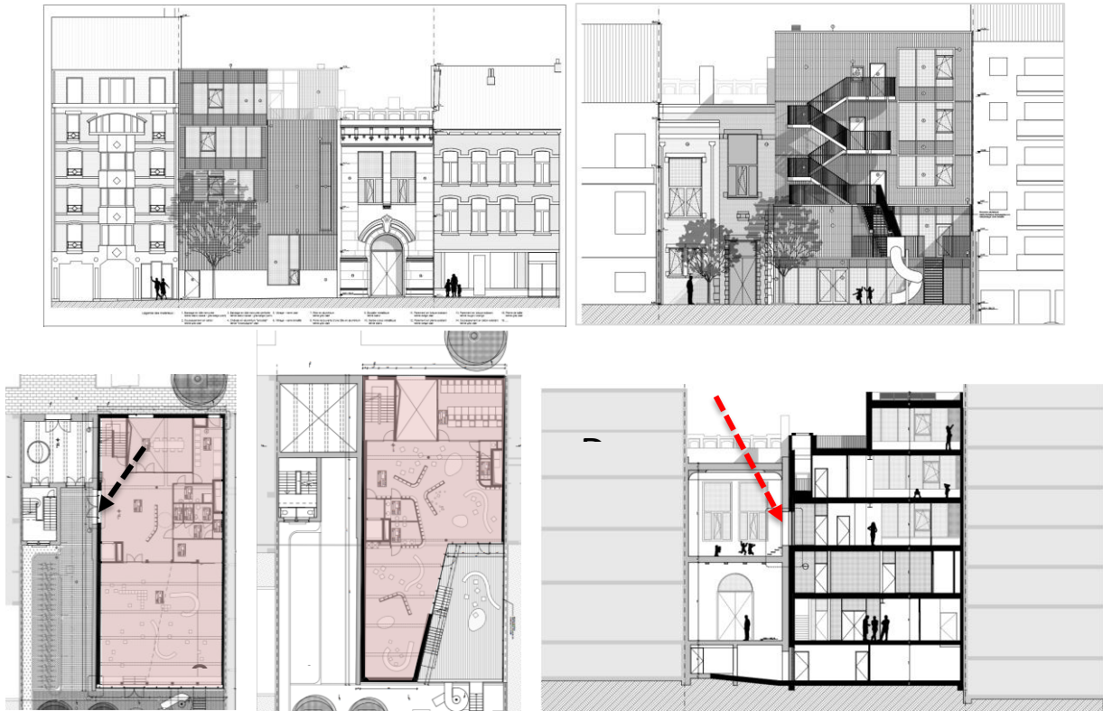
Plans des façades avant et arrière et des niveaux 00 et +01, coupe DD joints à la demande, avec indication des connexions
