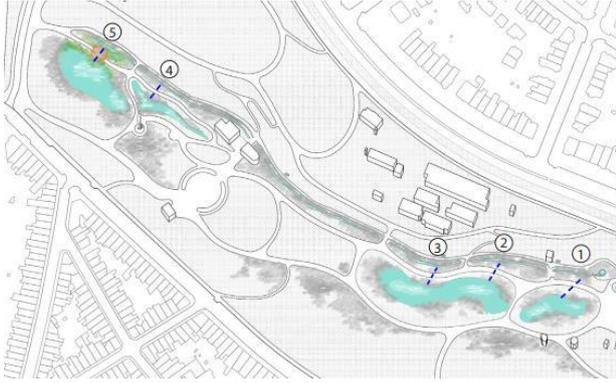
Schéma des nouvelles connexions entre ruisseaux et étangs
