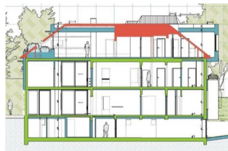
Coupe de synthèse des interventions. En vert : conservé En rouge : démoli En bleu : projet Image tirée du dossier de demande
