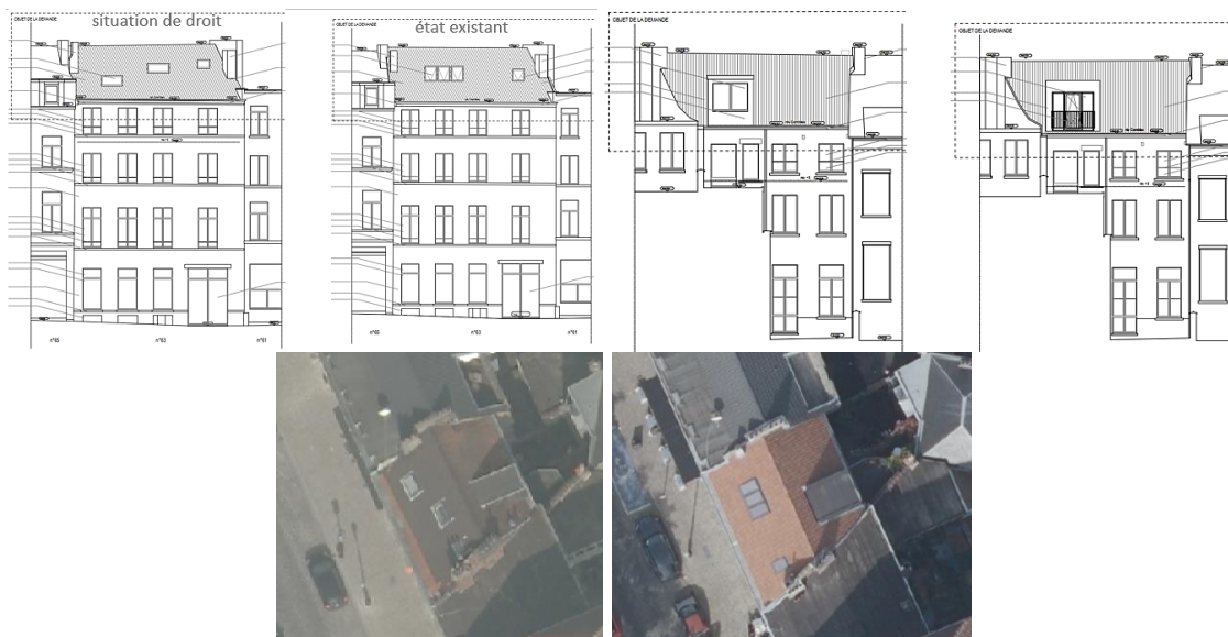
Situation avant et après travaux des toitures avant et arrière, extraits de la demande, état de la toiture en 2012 et 2021 (© Google maps)
