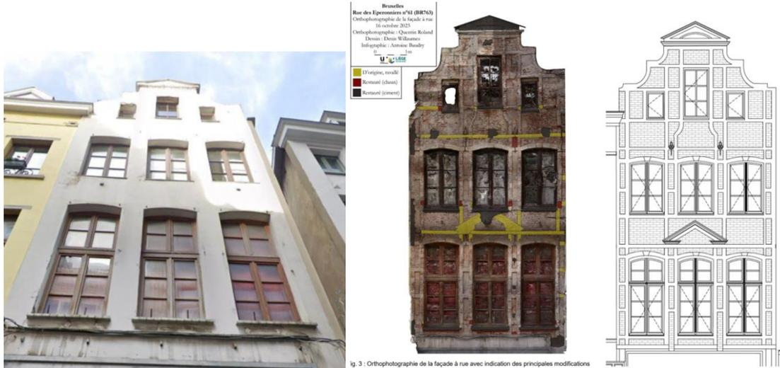
Fig. 3 : Orthophotographie de la façade à rue avec indication des principales modifications (Urban) et relevé du projet (extr. du dossier de demande)
