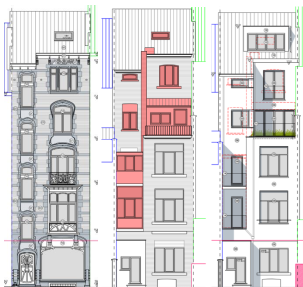
Elévations : façade avant projetée - façade arrière existante, avec démolitions, et projetée (extr. du dossier de demande)
