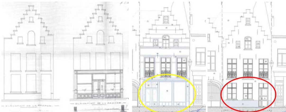
Permis de 1924 : situations existante et projetée Permis de 2021 : situations existante et projetée (extr. du dossier de demande)
