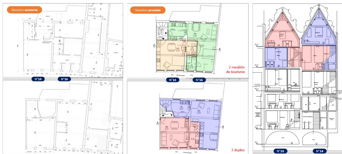
Étages +2 et +3, situation existante. Étages +2 et +3, situation projetée. Coupe de la situation projetée.
