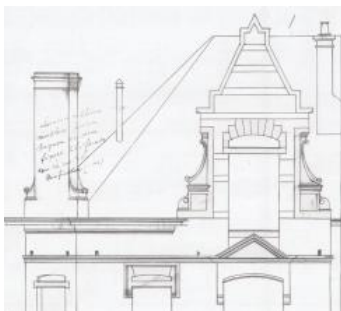
Élévation de droit du versant de toiture avant, côté Square Gutenberg. Plan de 1898.
