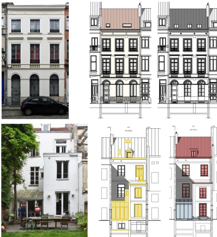
États existants et projetés des façades à rue et arrière, documents extraits de la demande
