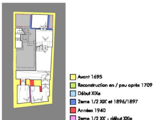
Datation des caves au Grand-Place, n°28. Plan extrait de l'état de référence.
