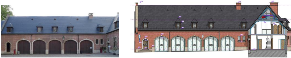
Façade est de l'aile ouest – situation existante et projetée (extr. du dossier de demande)
